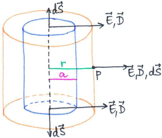
$$\iint_{B_1} \vec{D} \cdot d\vec{s} + \iint_{B_2} \vec{D} \cdot d\vec{s} + \iint_M \underbrace{\vec{D} \cdot d\vec{s}}_{D \cdot ds} = q$$
